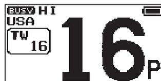
5. Al ricevimento di una trasmissione sul canale di priorità, **HX320E** rimane sul canale di priorità fino a quando non cessa il segnale in ingresso.
