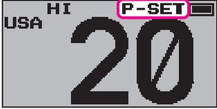
6. Ripetere le operazioni da 1 a 5 per programmare i canali aggiuntivi sui canali preimpostati. Si possono registrare fino a 10 canali. Se si tenta di registrare un 11° canale, si attiva un segnale acustico di errore.
