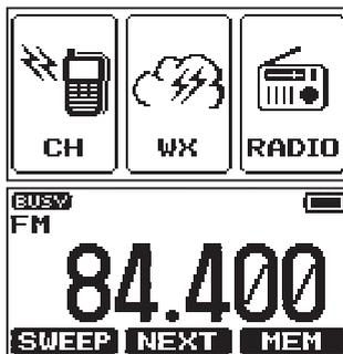
3. Per uscire dalla modalità di ricezione delle trasmissioni FM, premere il tasto **[MENU/SET]** per visualizzare la schermata MENU, quindi premere il tasto a sfioramento **[CH]**. Il ricetrasmittitore torna al canale in uso prima del passaggio alla banda di trasmissione FM.
