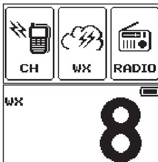
3. Per uscire dai canali meteo NOAA, premere il tasto **[MENU/SET]** per visualizzare la schermata MENU, quindi premere il tasto a sfioramento **[CH]**. Il ricetrasmittitore torna al canale in uso prima del passaggio alla modalità dei canali meteo.
