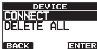
5. Premere i tasti [▲]/[▼], per selezionare dall'elenco le cuffie Bluetooth® da collegare. Quando il collegamento è terminato, viene visualizzato “Connected...”. Un segno di spunta “✔” viene visualizzato all'inizio della riga delle cuffie Bluetooth® collegate.
