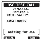
*Chiamata di prova DSC con inserimento manuale di un MMSI*
