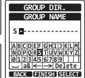
Se si effettua un errore durante la digitazione del nome, premere il tasto **[CH▼]/[CH▲]/[◀]/[▶]** per selezionare **"←"** oppure **"→"**, premere il tasto a sfioramento **[SELECT]** fino ad evidenziare il carattere errato, quindi eseguire le operazioni di cui ai punti 3 e 4.
