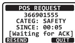
9. Il ricetrasmittitore, quando riceve la posizione dall'imbarcazione alla quale ha inviato la richiesta, attiva una suoneria e la posizione dell'imbarcazione interessata viene trasmessa ad un plotter cartografico GPS tramite NMEA 0183. (Per sentire la suoneria occorre abilitare l'opzione DSC BEEP.) Premere un tasto qualsiasi per arrestare l'allarme.
