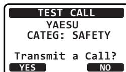
4. Al termine della trasmissione della chiamata di prova DSC, il ricetrasmittitore attende una risposta dalla radio che è stata chiamata e il display mostra “WAITING FOR ACK”.
