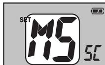
6. Después de finalizar su selección, desconecte y conecte el transceptor manteniendo pulsada la tecla .
